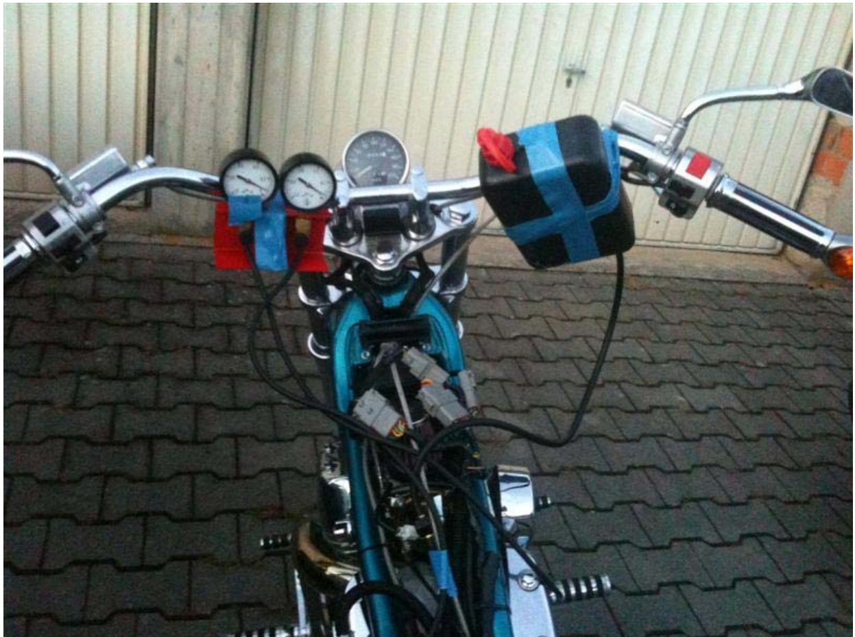
Abb. 5: Aufbau zum Synchronisieren während der Fahrt
