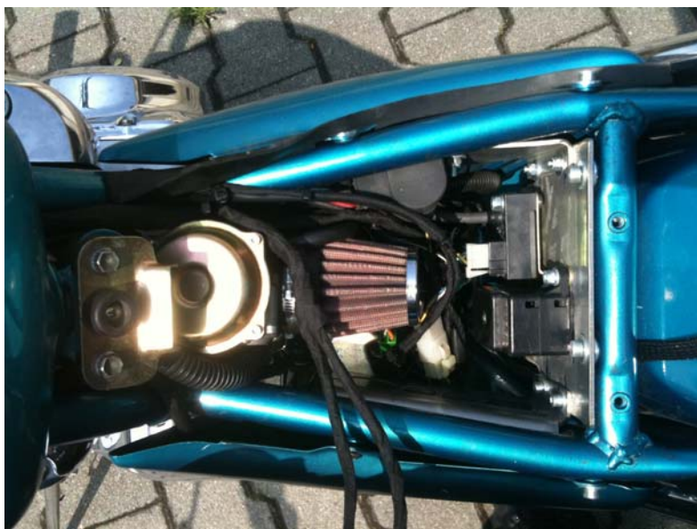
Abb. 4: Elektrikhalterung. Die Relais sind außen unter dem linken Seitendeckel montiert.
